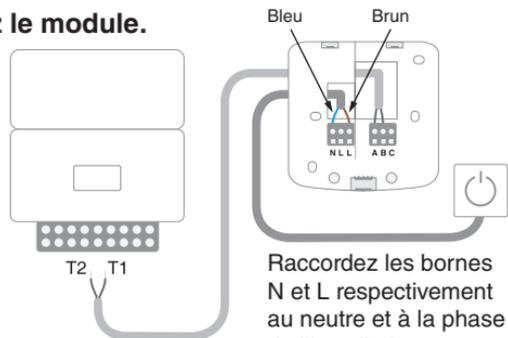
Raccordez les bornes N et L respectivement au neutre et à la phase de l'installation.
