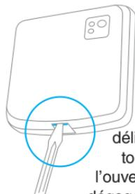
Introduisez délicatement un tournevis dans l'ouverture jusqu'à dégager totalement la languette.
