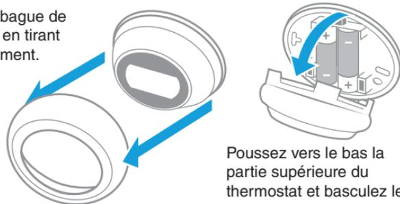
Poussez vers le bas la partie supérieure du thermostat et basculez le vers l'avant.
