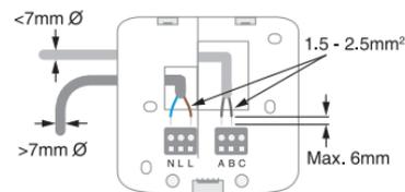
Fixez la base de montage sur la boîte encastrée ou directement au mur, à proximité de la chaudière.
