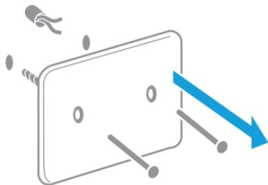
Atención: Este termostato no necesita cableado. Aísle los conductores e introdúzcalos en la pared.
