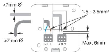
Fije la base de montaje en la caja encastrada o directamente en la pared, cerca de la caldera.
