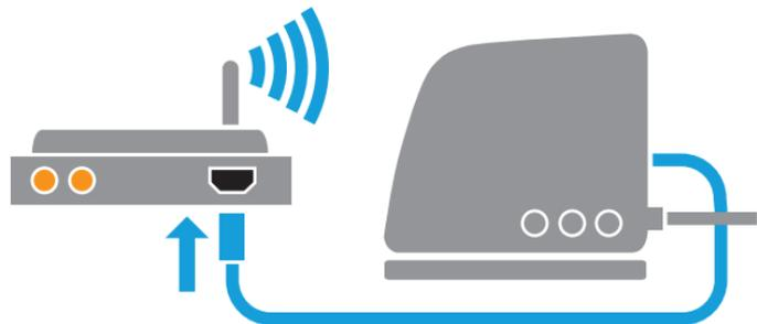
Si la conexión de Internet funciona correctamente el LED pasará de color rojo a verde intermitente.
