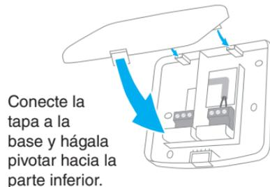
Conecte la tapa a la base y hágala pivotar hacia la parte inferior.
