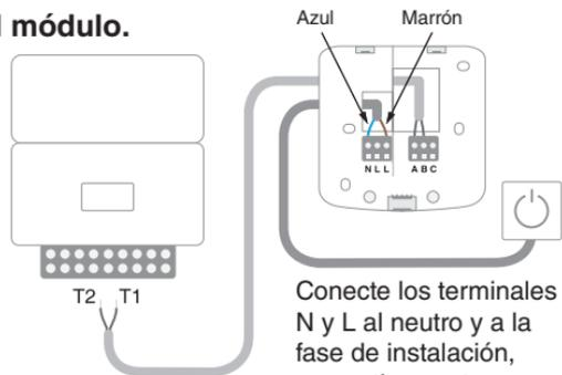
Conecte los terminales N y L al neutro y a la fase de instalación, respectivamente.
