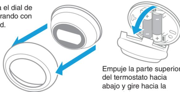
Empuje la parte superior del termostato hacia abajo y gire hacia la parte delantera.
