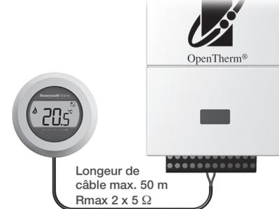
Consultez le manuel d'installation de la chaudière pour le bon raccordement au bornier OpenTherm.
