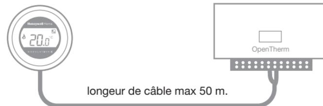
Consultez le manuel d'utilisation de la chaudière pour connaître les bornes de raccordement OpenTherm®.
