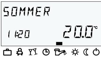
Bei manuellem Sommerbetrieb bleibt nur der Warmwasserkreis in Funktion und regelt die Wärmeerzeugertemperatur nach der vorgegebenen Warmwassertemperatur und dem vorgegebenem Warmwasser-Schaltzeitenprogramm. Der Heizbetrieb wird frostgesichert unterbunden.
