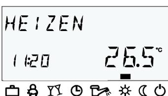
Die Betriebsart HEIZEN gewährleistet ständigen Heizbetrieb ohne zeitliche Einschränkungen nach der vorgegebenen Tagesraumtemperatur. Die Warmwasserbereitung arbeitet ständig nach vorgegebener Tages-Warmwassertemperatur.
