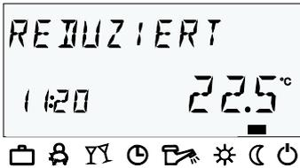
Die Betriebsart REDUZIERT bewirkt einen ständig reduzierten Heizbetrieb nach der vorgegebenen abgesenkten Raumtemperatur. In den Heizkreisebenen ist entsprechend die reduzierte Betriebsart ECO (frostgesicherter Abschaltbetrieb) bzw. ABS (Absenkbetrieb) eingestellt. Die Minimaltemperatur-Begrenzung des jeweiligen Heizkreises muss berücksichtigt werden.
