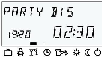
Der Partybetrieb bewirkt ein einmaliges Zwischenheizen aller Heizkreise bis zu einem vorgegebenen Zeitpunkt und überbrückt einen bevorstehenden oder bereits aktiven Absenkyklus ganz oder teilweise. Nach Ablauf der eingestellten Zeit kehren die Heizkreise selbstständig in die Betriebsart zurück, die vor dem Partyprogramm aktiv war. Kurzzeitprogramme wie ABWESEND oder PARTY werden dabei übersprungen.
