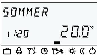
Menü "Systemparameter", Parameter Zeitprogramm = P1. Alle Heizkreise sowie der Warmwasserkreis richten sich ausschließlich nach den Standard- bzw. individuell programmierten Schaltzeiten im Parameter Zeitprogramm P1. Das Programm P1 erscheint in dieser Betriebsart nicht in der Anzeige (siehe 5.2.2 Menü "Schaltzeiten", S. 59 und 5.2.3.2 Zeitprogramm, S. 77).
