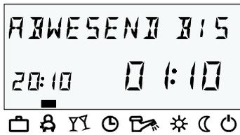
Mit der Betriebsart ABWESEND wird der Heizbetrieb bei kurzfristiger Abwesenheit vorübergehend frostgesichert abgeschaltet. Während der Abwesenheit werden alle Heizkreise nach der vorgegebenen gesenkten Raumtemperatur geregelt. Nach Ablauf der eingestellten Zeit kehren die Heizkreise selbstständig in die Betriebsart zurück, die vor dem Wechsel in den Abwesenheitsbetrieb aktiv war. Kurzzeitprogramme wie PARTY oder ABWESEND werden dabei übersprungen.
