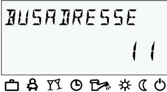
Mit einem digitalen Wandgerät ist neben der Raumtemperatur-Erfassung die Bedienung eines Zentralgeräts aus der Ferne (z. B. aus einem Wohnraum) möglich. Es können Einstellungen für alle vorhandenen Heizkreise vorgenommen werden.
