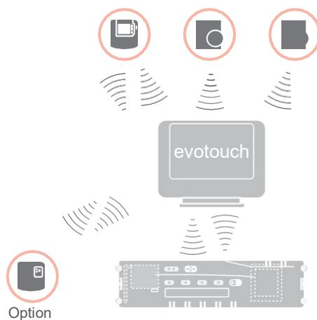
Sistema di regolazione di zona con apparecchio di comando CM927
