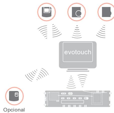
Sistema controlador para suelo radiante con aparato de mando CM927
