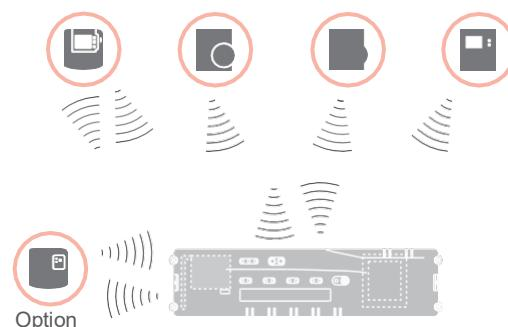
Système de régulation pour plancher chauffant ou rafraîchissant sans module d'ambiance programmable central
