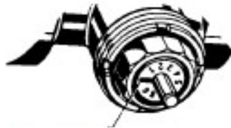
Ranura de destornillador para ajustar el tornillo de pre-ajuste
