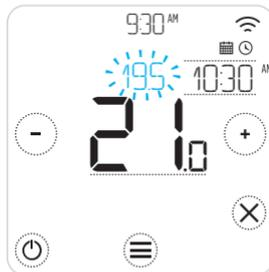
2. Während der Temperaturanpassung wird die Bis-Zeit ("Bis"-Zeit) angezeigt.
