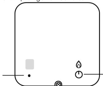
Drücken Sie auf die Handbetätigung, um zu prüfen, ob der Heizkessel eingeschaltet wird. LED-Taste leuchtet grün.
