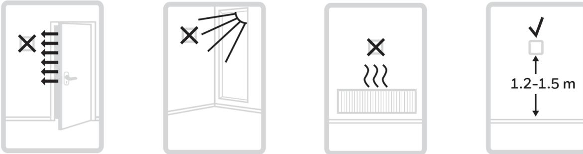
Der Lyric T6 Thermostat darf nicht an Stellen mit Zugluft oder direkter Sonneneinstrahlung bzw. neben Wrmequellen installiert werden. Er sollte sich mindestens 1,2 bis 1,5 Meter ber dem Boden befinden.
