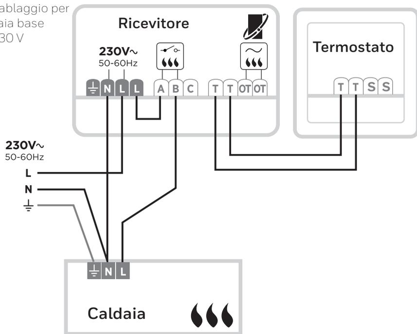
B) Cablaggio per caldaia combinata
