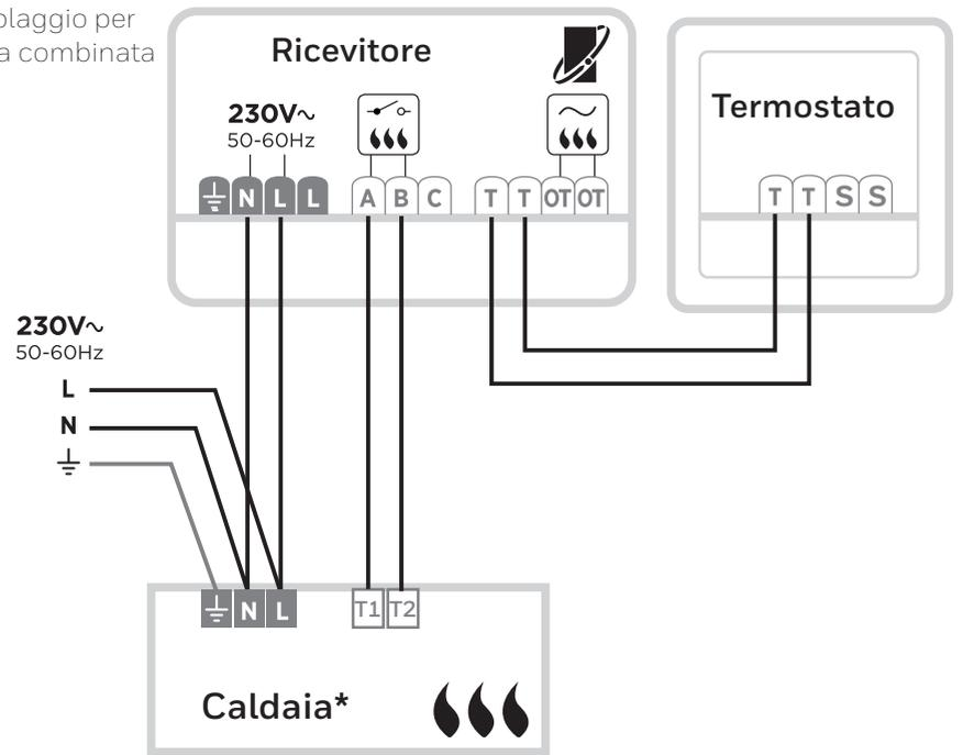
C) Cablaggio per caldaia OpenTherm
