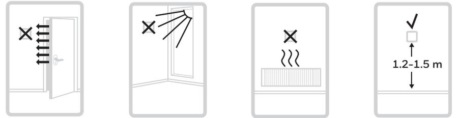
Il termostato T6 non deve essere collocato presso correnti d'aria o fonti di calore, né esposto alla luce solare diretta. Deve essere situato ad almeno 1.2 - 1.5 metri dal pavimento.
