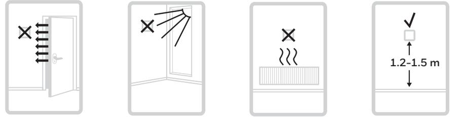
Das T6 Thermostat darf nicht an einer Stelle mit Zugluft oder direkter Sonneneinstrahlung bzw. neben Wärmequellen installiert werden. Es sollte sich wenigstens 1.2 - 1.5 m über dem Boden befinden.
