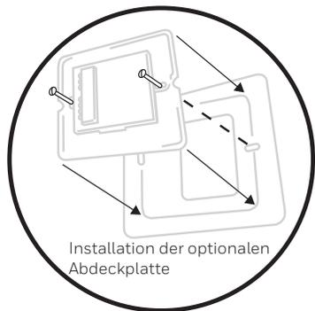
**A)** Mit einem Schraubendreher die Wanddosenklemmenabdeckung öffnen, um die Drähte anzuschließen.
