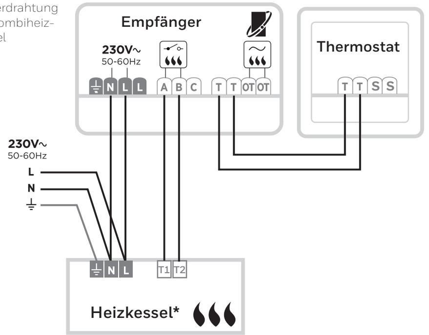
C) Verdrahtung für OpenTherm-Heizkessel
