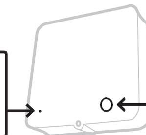
Appuyez sur le bouton **une fois** pour vous assurer que la chaudière est mise sous tension - La LED du bouton doit s'allumer, de façon permanente, et être de couleur JAUNE. Appuyez une nouvelle fois pour couper l'alimentation de la chaudière - La LED du bouton doit s'éteindre
