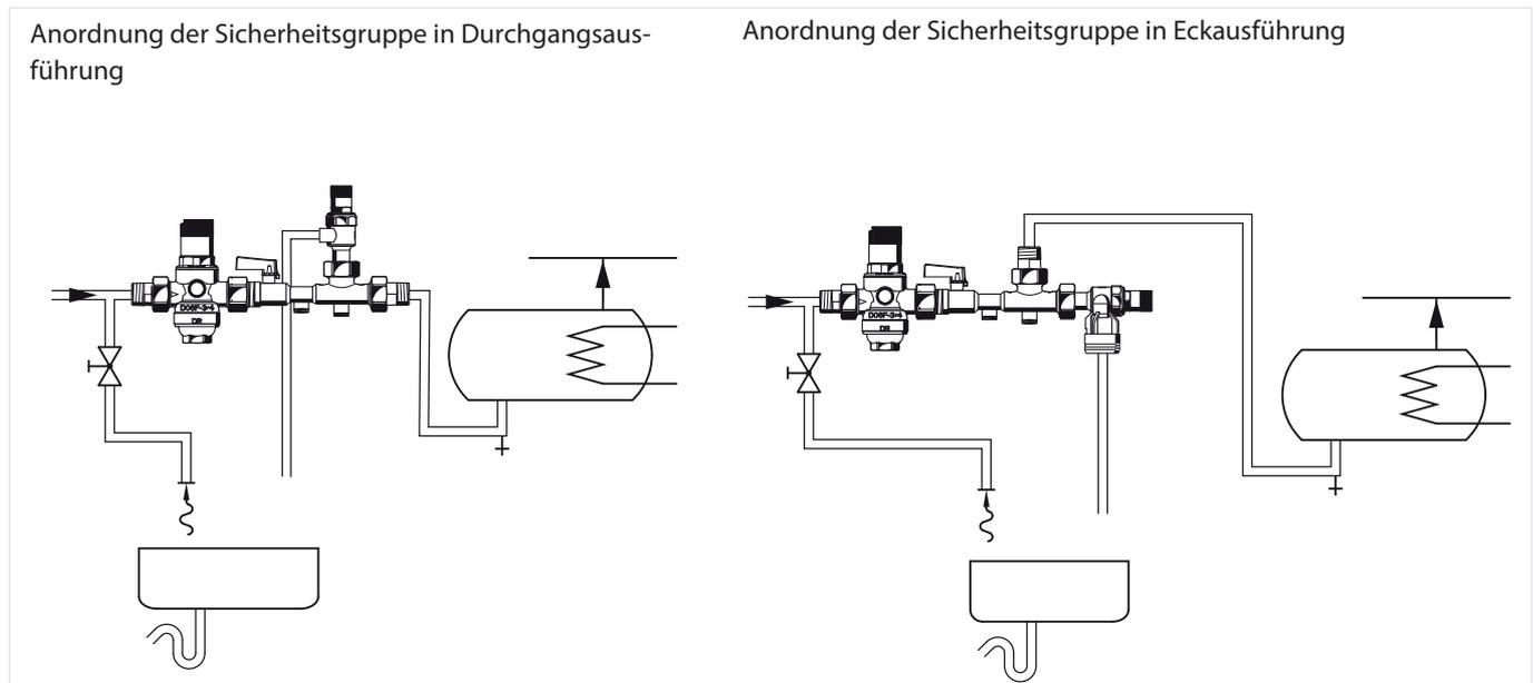
Abb. 1 Beispiel für den standardmäßigen Einbau der Sicherheitsgruppe
