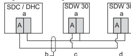
Fig. 1: Conexión del SDW 30 al dispositivo central
