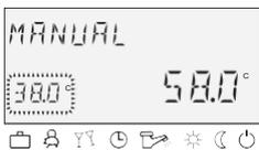
El valor prescrito del generador de calor se ajusta entre las temperaturas mínima y máxima del generador de calor y aparece parpadeando abajo a la izquierda. La actual temperatura del generador de calor aparece estática a la derecha en el indicador principal. La diferencia de conexión ajustada corresponde al valor de la regulación automática y es simétrica al valor ajustado.
