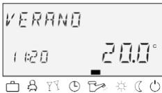
Durante el servicio de verano manual queda funcionando únicamente el circuito de agua caliente y regula la temperatura del generador de calor según la temperatura del agua caliente y el programa horario de agua caliente predeterminado. El servicio de calefacción se detiene con protección contra heladas.
