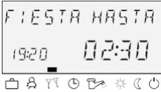
El servicio festivo causa una única calefacción intermedia de todos los circuitos de calefacción hasta un momento predeterminado y puentea total o parcialmente un ciclo de ahorro por acontecer o que ya está activo. Después de transcurrir el tiempo ajustado, todos los circuitos de calefacción retornan automáticamente al modo de funcionamiento que estuvo activo antes del programa festivo. Los programas por corto tiempo como AHORRO HASTA o FIESTA HASTA se pasan aquí de largo.
