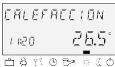
El modo de funcionamiento CALEFACCION garantiza servicio de calefacción permanente sin limitaciones de tiempo, de acuerdo a la temperatura ambiente confort predeterminada. El calentamiento de agua trabaja permanentemente, de acuerdo a la temperatura del agua caliente sanitaria predeterminada.
