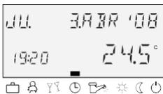
Menú "Parámetros de sistema", parámetro programa horario = P1. Todos los circuitos de calefacción así como el circuito de agua caliente se orientan exclusivamente por la programación horaria de fábrica o individual en el parámetro Programa horario P1. El programa P1 no aparece en este modo de funcionamiento en el indicador (ver 4.2.2 Menú "Programación horaria", pág. 36 y 4.2.3.2 Programa horario, pág. 54).
