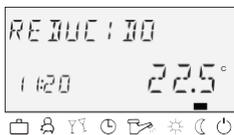
El modo de funcionamiento REDUCIDO garantiza un servicio de calefacción permanente reducido, de acuerdo a la temperatura ambiente ahorro predeterminada. En los niveles de circuito de calefacción está respectivamente ajustado el modo de funcionamiento reducido ECO (bomba desactivada protegido contra heladas) o RED (funcionamiento modo de ahorro). Debe tenerse en cuenta la mínima limitación de temperatura del respectivo circuito de calefacción.
