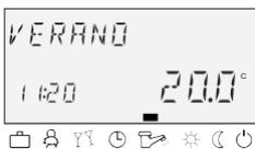
Menú "Parámetros de sistema", parámetro programa horario = P1. Todos los circuitos de calefacción así como el circuito de agua caliente se rigen exclusivamente por la programación horaria de fábrica o individual en el parámetro Programa horario = P1. El programa P1 no aparece en este modo de funcionamiento en el indicador (ver 4.2.2 Menú "Programación horaria", pág. 36 y 4.2.3.2 Programa horario, pág. 54).
