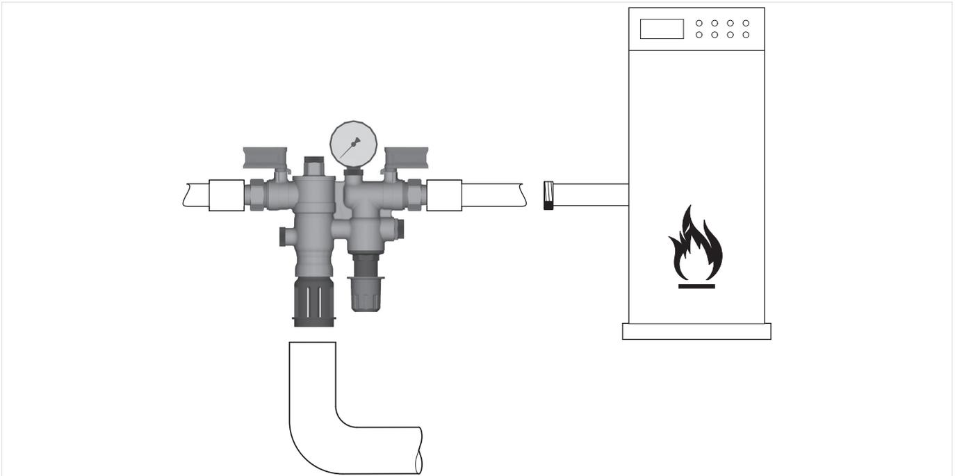
Abb. 1 Beispiel für den standardmäßigen Einbau der Nachfüllkombination
