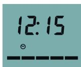
La pressione singola del tasto [IMPOSTA] immette i minuti e commuta il display in modalità di impostazione della durezza. Questa è visualizzabile in ppm, gradi tedeschi o gradi francesi a seconda del modello di addolcitore.
