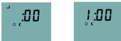
En pressant une fois la touche [ENTRÉE], l'heure de régénération est validée et l'affichage passe au mode de réglage du type de sel utilisé.
