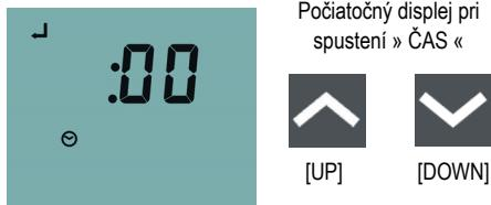
Čas sa upravuje pomocou tlačidiel [UP], [DOWN]. Stlačením tlačidla [SET] sa zadávajú hodiny. Minúty sa nastavujú tlačidlami [UP], [DOWN].
