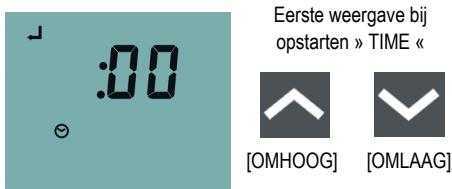
De tijd wordt aangepast met behulp van de [UP], [DOWN] toetsen. Druk op de toets [SET] om de uren in te voeren. De minuten worden ingesteld met behulp van de toetsen [UP] en [DOWN].
