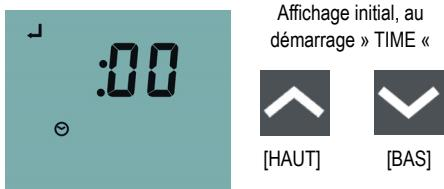
L'heure est à paramétriser en utilisant les touches [UP] (haut), [DOWN] (bas). On valide l'heure en pressant la touche [SET] (entrée). Les minutes sont paramétrées en utilisant les touches [UP] (haut), [DOWN] (bas).
