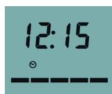
Jedným stlačením tlačidla [SET] zadáte minúty a displej prejde do režimu Zadať tvrdosť. Tá môže byť zobrazená v ppm, nemeckých stupňoch alebo francúzskych stupňoch v závislosti od modelu zmäkčovača.
