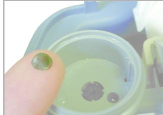
7. Linsensieb mit Linsenwölbung nach unten einlegen
