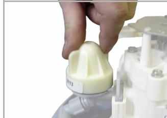
3. Dichtungsring, Distanzstück sowie Filterelement herausnehmen
