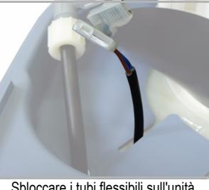
5. Sbloccare i tubi flessibili sull'unità disinettante premendo il dispositivo di sicurezza di scarico e con leggera pressione del tubo flessibile in direzione dell'unità disinettante. Disinserire i tubi flessibili sul lato di ingresso e di uscita
