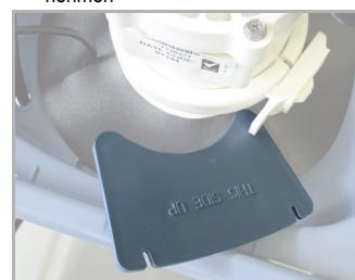
3. Stecker der Desinfektionseinheit durch Manschette fädeln
