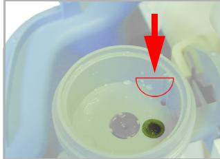
8. Flachdichtung mit Beschriftung nach oben einsetzen
