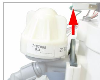
3. Quite la bomba de succión y sustituya la junta tórica (Fig. 1, Pos. 1)
