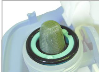
13. Deckel Saugstrahlpumpe handfest (ohne Werkzeug) aufschrauben
