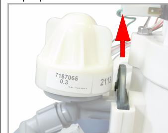
3. Saugstrahlpumpe abziehen und O-Ringe (Abb. 1 Pos. 1) austauschen
