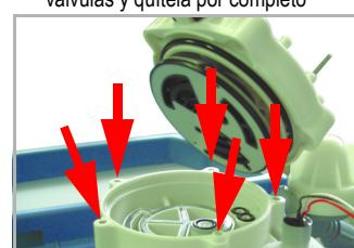
Para el mantenimiento del juego de retenes del cabezal de control hay que sustituir las siguientes juntas:
