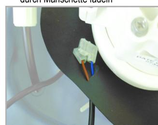
4. Kabel Desinfektionseinheit durch
