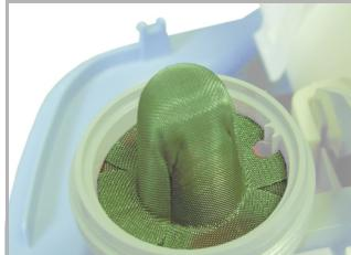
12. Filtersieb, Distanzstück und Dichtungsring einsetzen
