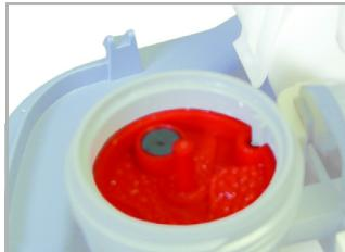
11. Düse mit Schrift nach oben einsetzen
