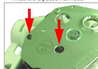
5. Svitare quindi il collegamento a vite del coperchio del blocco ventola e rimuovere completamente il coperchio
