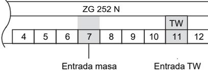
**i** En el termostato MCR 200 las entradas TW y masa están según el modelo en los siguientes bornes.
