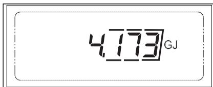
Per passare alle schermate successive del gruppo, premere brevemente il pulsante P1. La schermata dell'ultimo menu è quella di test del display, che fa illuminare tutti i segmenti del display LCD. Dopo aver raggiunto l'ultima voce del gruppo, una pressione breve del pulsante riporta il display alla schermata dell'energia principale. Si può anche raggiungere la schermata dell'energia principale da qualsiasi posizione nel gruppo tenendo premuto il pulsante P1.
