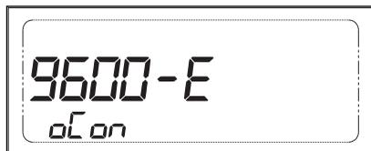
A seconda della configurazione del calcolatore, il terzo sottogruppo contiene la parte meno significativa del registro dell'energia principale e può anche contenere le parti meno significative del registro della tariffa dell'energia. Le schermate illustrate di seguito sono esempi di schermate dell'energia principale (registro principale e registro della parte più recente).
