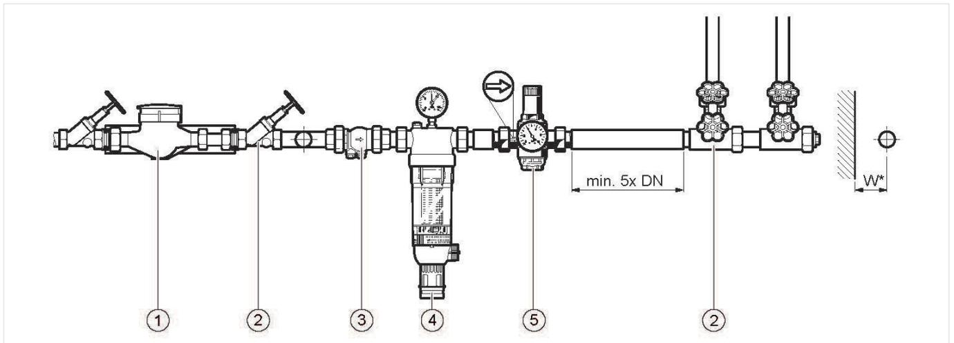
Fig. 1 Exemple d'installation standard pour régulateur de pression
