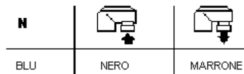
Colore dei cavi per attuatori a 230V (M6410L)
